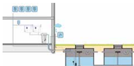
Schema van het regenwatersysteem van Mijn Waterfabriek.
